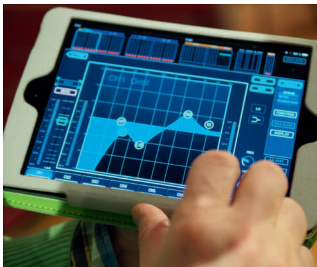
Niclas Rosqvist med ett av de verktyg som han använder mest under gradgivingarna i Malmö PB - en iPad. På bilden här under kan du se en närbild hur det ser ut på pekskärmen på Niclas iPad under drift. Genom att med fingret dra i de runda cirklarna på skärmen kan han enkelt ändra bas och diskant - trådlöst till och med från en annan våning (!)
